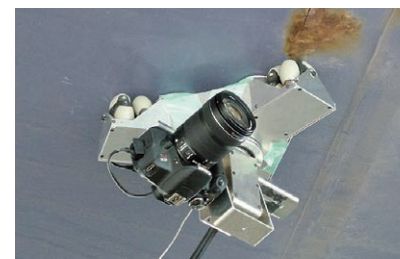
構造物の垂直壁面、湾曲壁面、背面に吸着し全方位に移動可能
